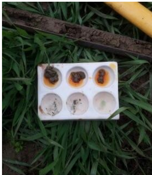
Slike 4 i 5. Uzimanje uzorka i analiza pH na terenu
